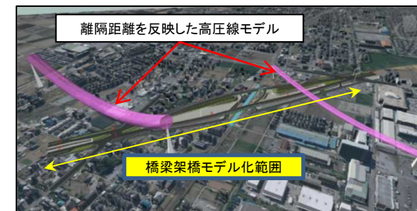
橋梁と架空線の離隔確認
